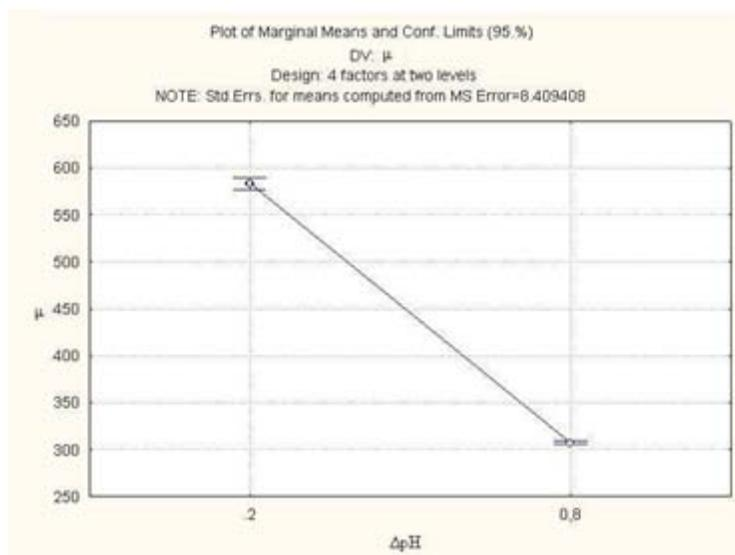
**Fig. 8 Efecto del  $\Delta pH$  sobre la viscosidad.**
