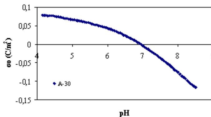
Fig. 2 Curva de estabilidad de la muestra A30.
