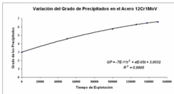
Fig. 2 Variación del grado de los precipitados con el tiempo de explotación
