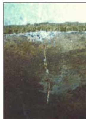
Fig. 2 Ejemplo típico de descincado
